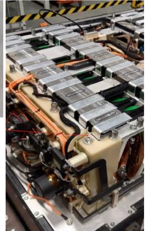
\mu HPs montés sur une batterie automobile
