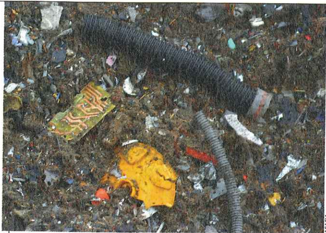
C'est ce résidu de broyage qui constitue la matière première : un kilo représente potentiellement un demi-litre de carburant.
