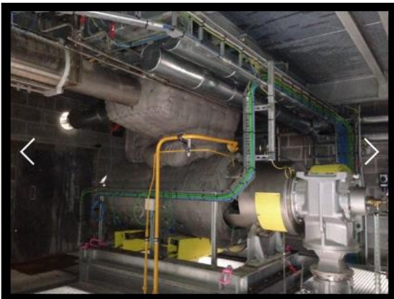
Cette unité pilote a une capacité de traitement de plus de 250 kg/h de résidus de broyage.
